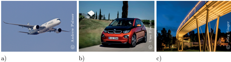
Abbildung 1.1: Alltagsprodukte mit faserverstärkten Materialverbänden und dynamischen Beanspruchungen. a) Airbus A350 XWB mit 53 % CFK-Anteil [4], b) BMW i3 mit CFK-Karosserie [5], c) glasfaserverstärkte Betonbrücke in Albstadt [6]
