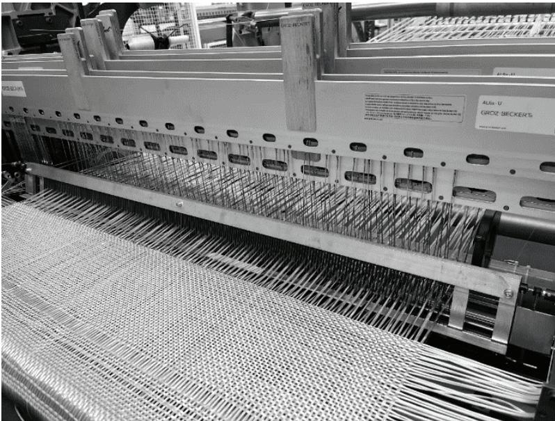
Abbildung 4-4: Implementierung des breitenvariablen Webblattes in eine Dornier Greiferwebmaschine P1
