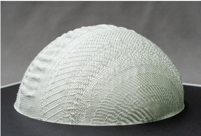
Abbildung 8-5: Abzugsfrei gewebte Halbkugel
