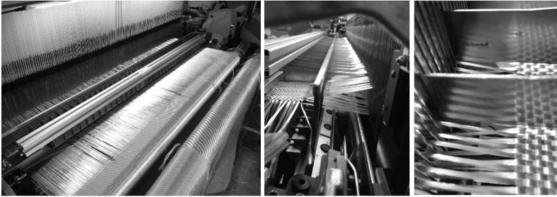
Abbildung 6-7: Einbau und Einstellung des oberen Hakensystems
