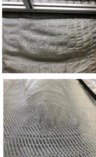
Zur Überprüfung der schalenförmigen Formschulter erfolgt die Überprüfung der erzeugten unterschiedlichen Kettfadenslängen innerhalb der Struktur. Dazu werden innerhalb eines definierten Abstandes (5 cm) die Bogenlängen der Kettfäden und die dazugehörigen Grundlängen gemessen (vgl. Tabelle 8-2). Die maximale Abweichung zwischen den gemessenen Längenverhältnissen und den längenerzeugenden Schussdichtenverhältnissen beträgt 5,1 %.
