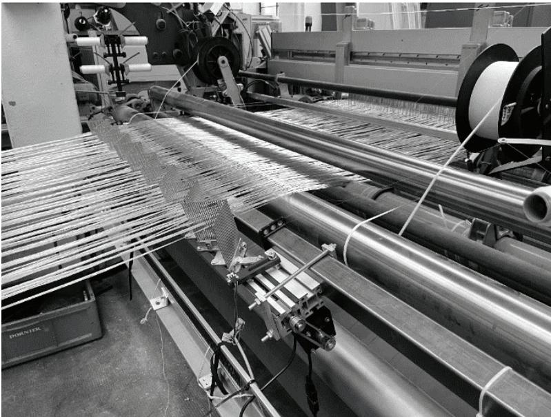
Abbildung 4-6: Installation eines Expansionskammes im Hinterfach der Webmaschine
