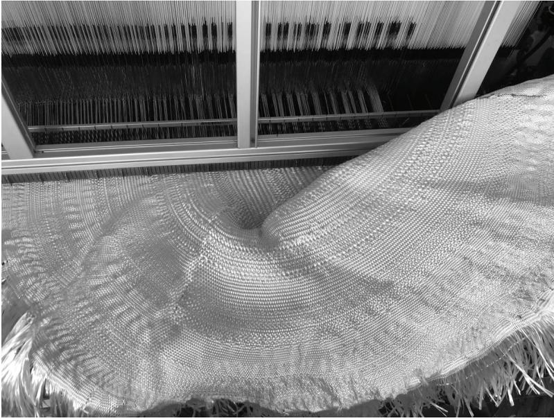
Abbildung 8-9: Fertigung des spiralförmigen Gewebes zur Ausbildung einer Trichtergeometrie
