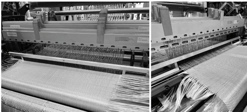
Abbildung 4-10: Herstellung der breitenvariablen Gewebe auf einer Greiferwebmaschine des Typs Dornier P1, links: Musterbeginn (breites Gewebe), rechts: Musterfertigung (schmales Gewebe)
