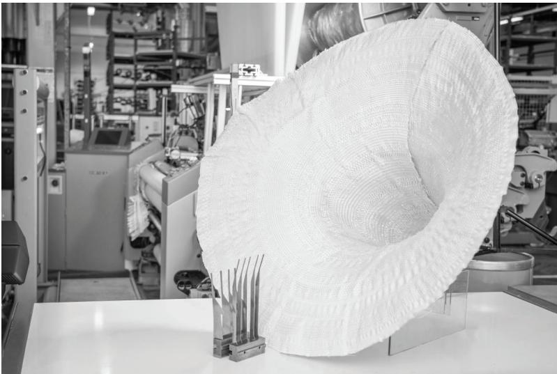
Abbildung 8-10: Abzugsfrei gewebte Trichtergeometrie
