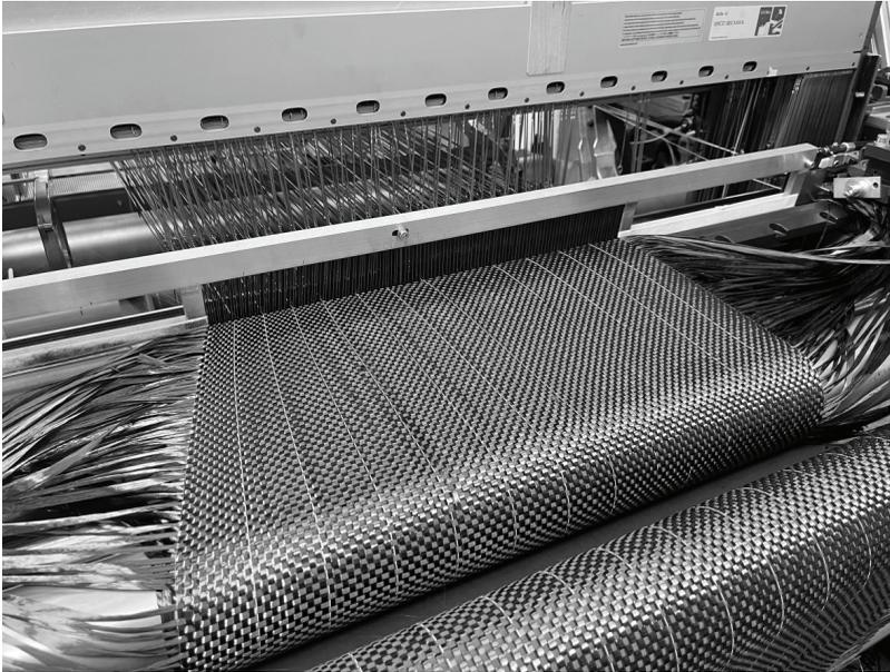
Abbildung 4-24: Weben der Gewebepreform eines Fanblades mittels breitenvariablen Webblattes
